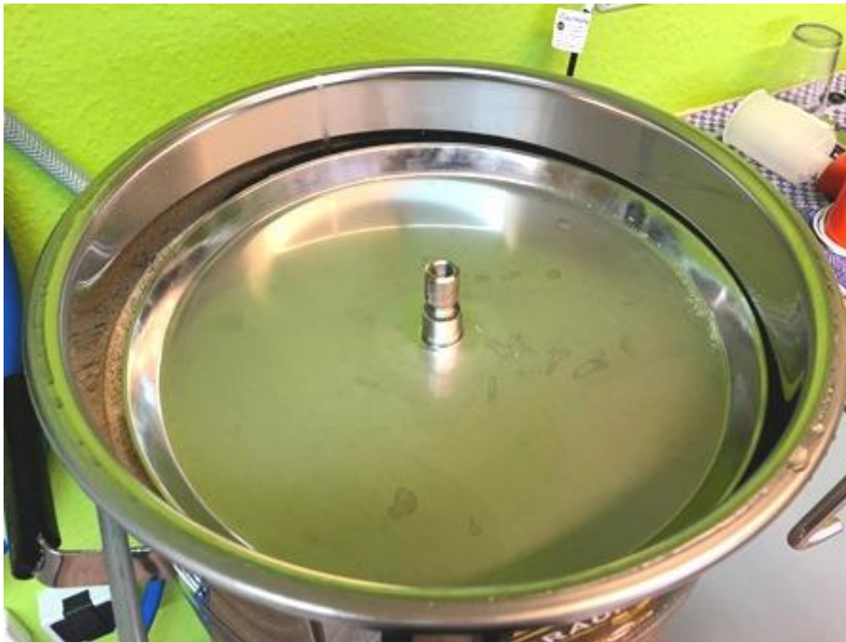
Schwimmdeckel auflegen während des gesamten Brauprozesses.
