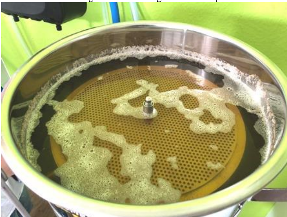
Schwimmdeckel auflegen während des gesamten Brauprozesses.
